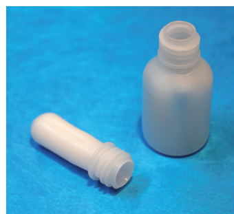
Spritzgegossener Vorformling und ein aufgeblasenes Augentropfenfläschchen
